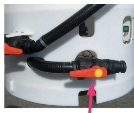
Vanne 3 voies (remplissage)
